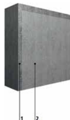
1 alusta betonista 2 vettähylykivä impregnointi
