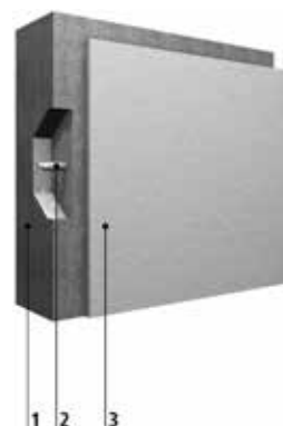
1 Alusta betonista 2 Korroosiosuojaus ja oikaisu 3 Tasoituslaasti
