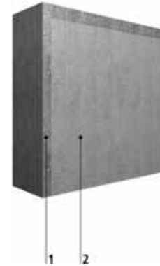
1 Alusta betonista 2 Vettähylykivä impregnointi
