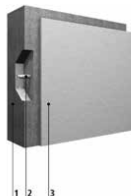
1 Alusta betonista 2 Korroosionsuojaus ja oikaisu 3 Tasoituslaasti
