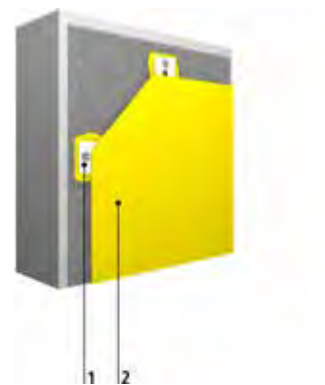
1 StoGold Fill StoGuard Strip:in kanssa 2 StoGold Coat
