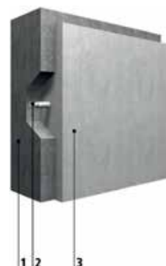
1 alusta betonista 2 korroosionsuojaus 3 korjauslaasti
